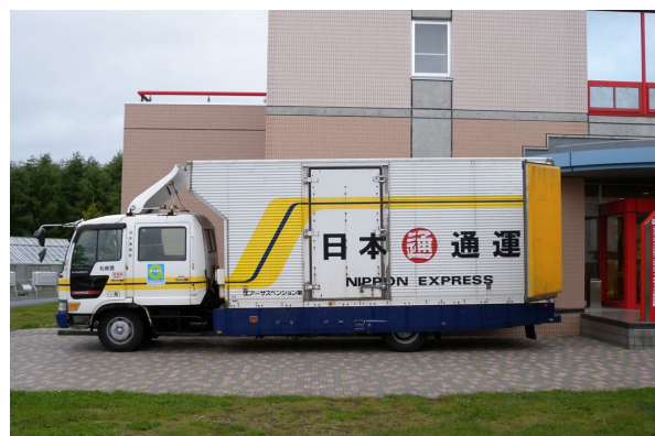
日本通運の美術品専用車。ダブルキャビンでエアサスペンションを備える。後方座席はクーリエ用
